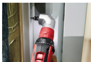
S úhlovým nástavcem lze šroubovat i ve velmi těsných prostorách.
