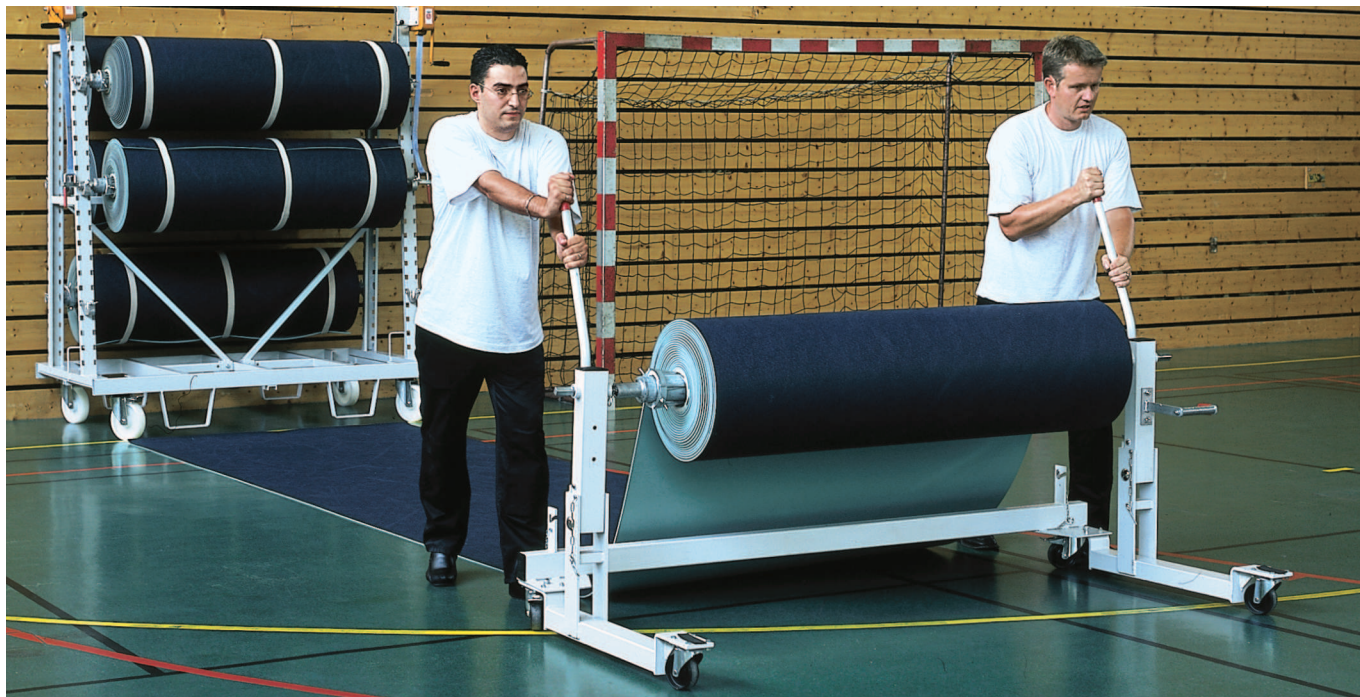
Odvíjení zakrývací krytiny s transportním a odvíjecím zařízením
